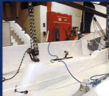
Une quille pivotante qui, en position relevée, entre dans un carénage qui sert aussi de cale-pieds.
