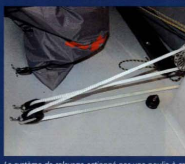
Le système de relevage actionné par une poulie à crans
